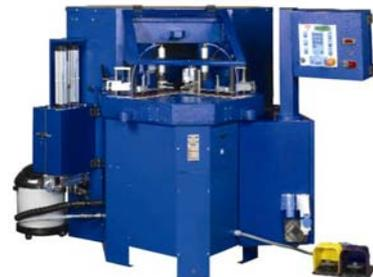
**SERTISSEUSE ITACA SOLUTION**, La machine a deux têtes opératrices équipées des blocs porte- couteaux réglables sur toutes les positions de sertissage. Les blocs se déplacent et sont réglables sur l'axe Y (long du profil), sur l'axe Z (haut - bas) et sur l'axe X (loin - près du profil).
